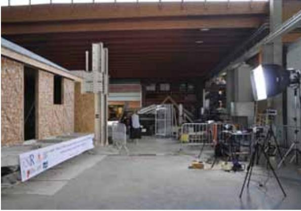
Grâce à l'utilisation d'une caméra rapide, enregistrant 150 images par seconde, et à l'utilisation d'un logiciel de corrélation d'image développé par le laboratoire 3SR (Tracker), la déformée d'un mur de cisaillement (ici augmentée 50 fois) a été analysée et des phénomènes imperceptibles à l'œil nu ont pu être mis en lumière.
