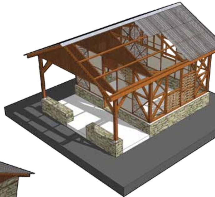
MODÈLE DE MAISON «TI'KAY» EN OSSATURE BOIS ET REMPLISSAGE EN PIERRES, ADOBES OU CLISSAGE
