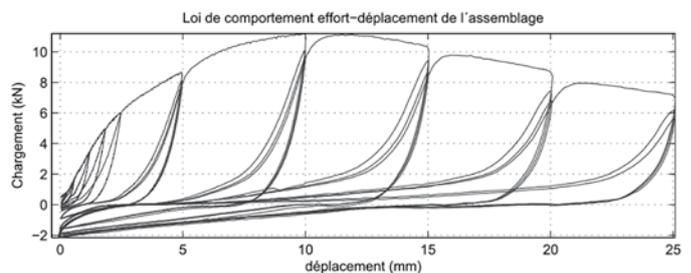
Les essais permettent d'établir les lois de comportement effort-déplacement et ainsi d'estimer l'énergie dissipée par la structure.
