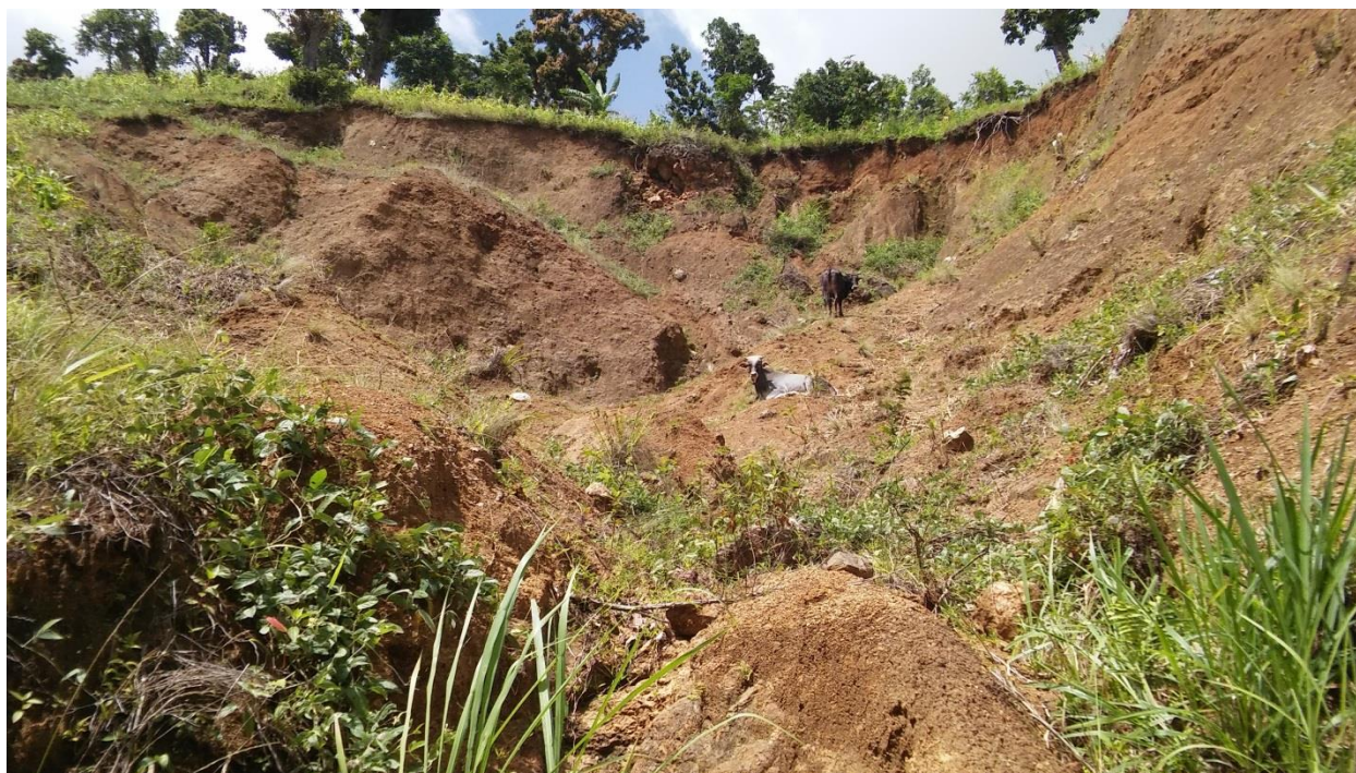
Figure .... Photo glissement observe dans le basalte altéré, localité la Source, cyclone Mathew .
